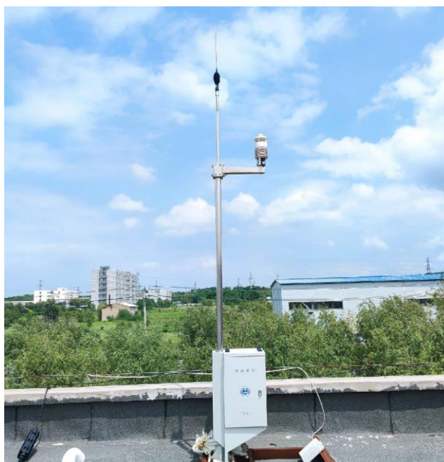
佳化抚顺安装噪声监控仪
